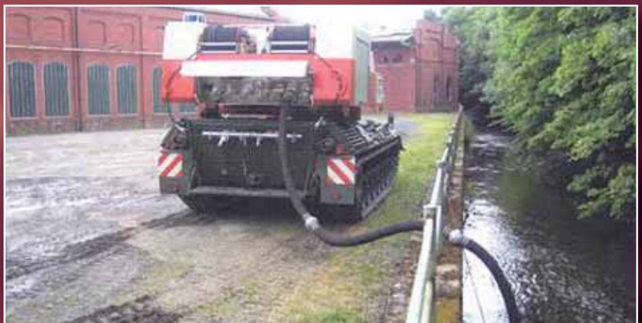
Πλήρωση της δεξαμενής νερού από φυσικές πηγές λήψης νερού
